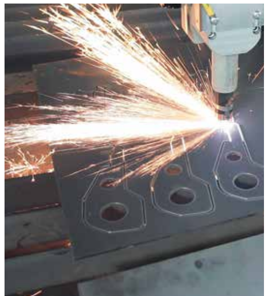
Qualitätssprung: Das linke Bauteil wurde noch vor dem Kauf mit einer Handplasmaanlage geschnitten. Mittig das präzise, mit der KNUTH Plasma-Jet geschnittene Bauteil.
