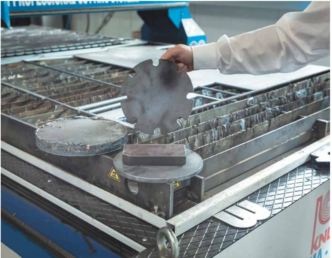
Qualitätssprung: Das linke Bauteil wurde noch vor dem Kauf mit einer Handplasmaanlage geschnitten. Mittig das präzise, mit der KNUTH Plasma-Jet geschnittene Bauteil.
