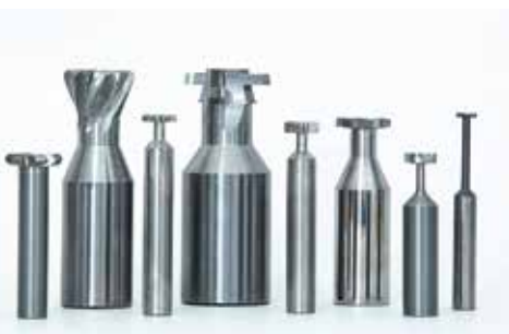
Mit T-Nutenfräsern lassen sich anspruchsvolle Geometrien in einem Arbeitsgang realisieren. Gerade bei diesen Werkzeugen sind Hartmetallsubstrat, Geometrie sowie Details wie Spanteiler und Hinterschliff entscheidend. So konnte in einem Fall die Prozesszeit um rund 85 Prozent reduziert werden.
