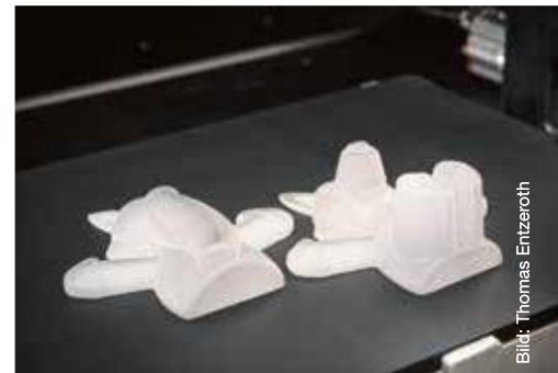
Kunststoff-Modell des Maskottchens, hergestellt im 3D-Druck-Verfahren als Form für das Silikon-Negativ.
