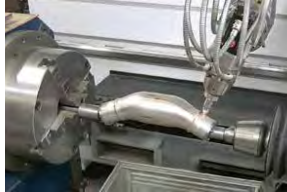
Auf der TruLaser Cell 7040 werden Drück- und Tiefziehteile wie auch Gehäuse, Apparatebauteile und Rohre bis 1500 mm Durchmesser bearbeitet.
