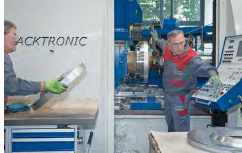
Ständige Investitionen: Technologisch gehören die hydraulisch gesteuerten Metalldrückanlagen zu den Rolls-Royce-Systemen unter den Metalldrückmaschinen.
