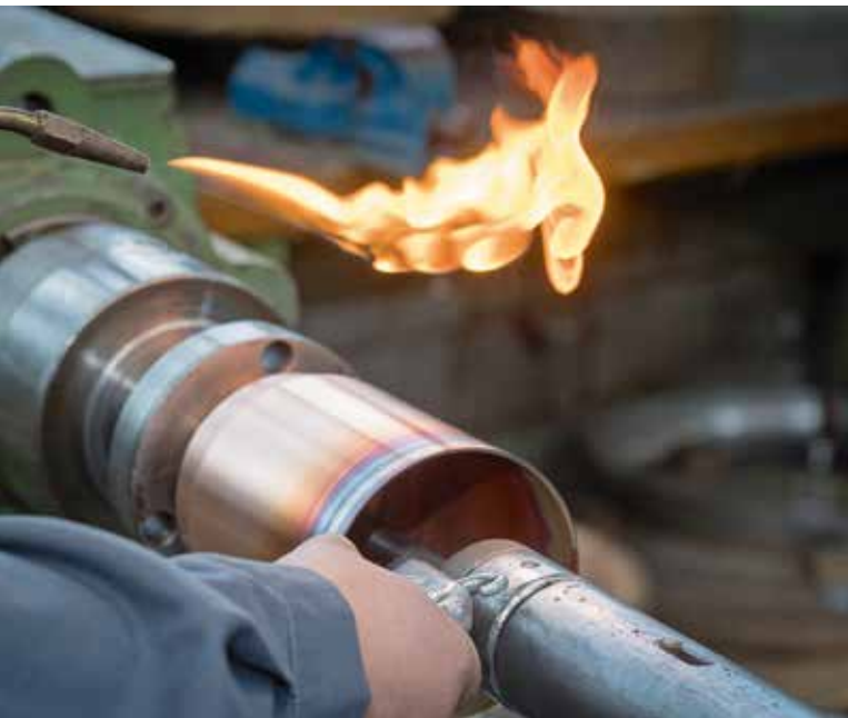
Mittels Metalldrückverfahren können rotationssymmetrische Werkstücke gefertigt werden. Die rotationssymmetrischen Blechumformteile bei Heggli & Gubler können bis 1600 mm Durchmesser gross sein.
