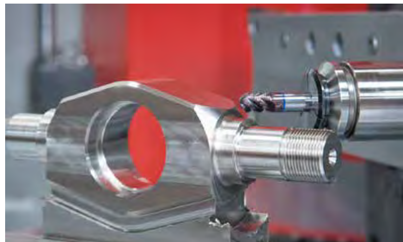
Hier kommen moderne Frässtrategien voll zum Tragen: Aus dem Block gefrästes Bauteil aus rostfreiem Stahl.
