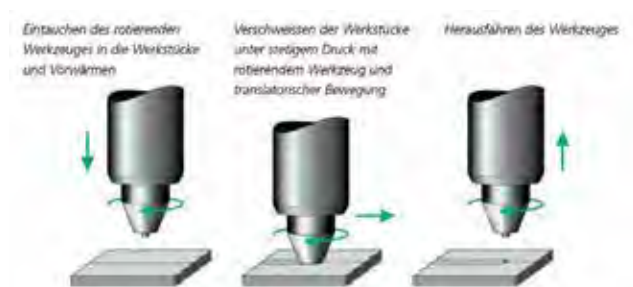
Prinzipkizze Rührreibschweissen FSW
