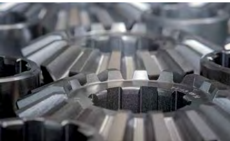
Das Unternehmen beherrscht u. a. die komplette Zahnradfertigung inklusive Innenverzahnung per Stoss-Verfahren, Wärmebehandlungsverfahren inklusive.
