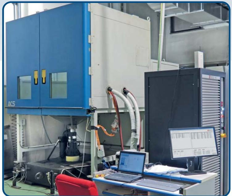
Prüfstand der Firma Digatron für Elektrofahrzeugbatterien
