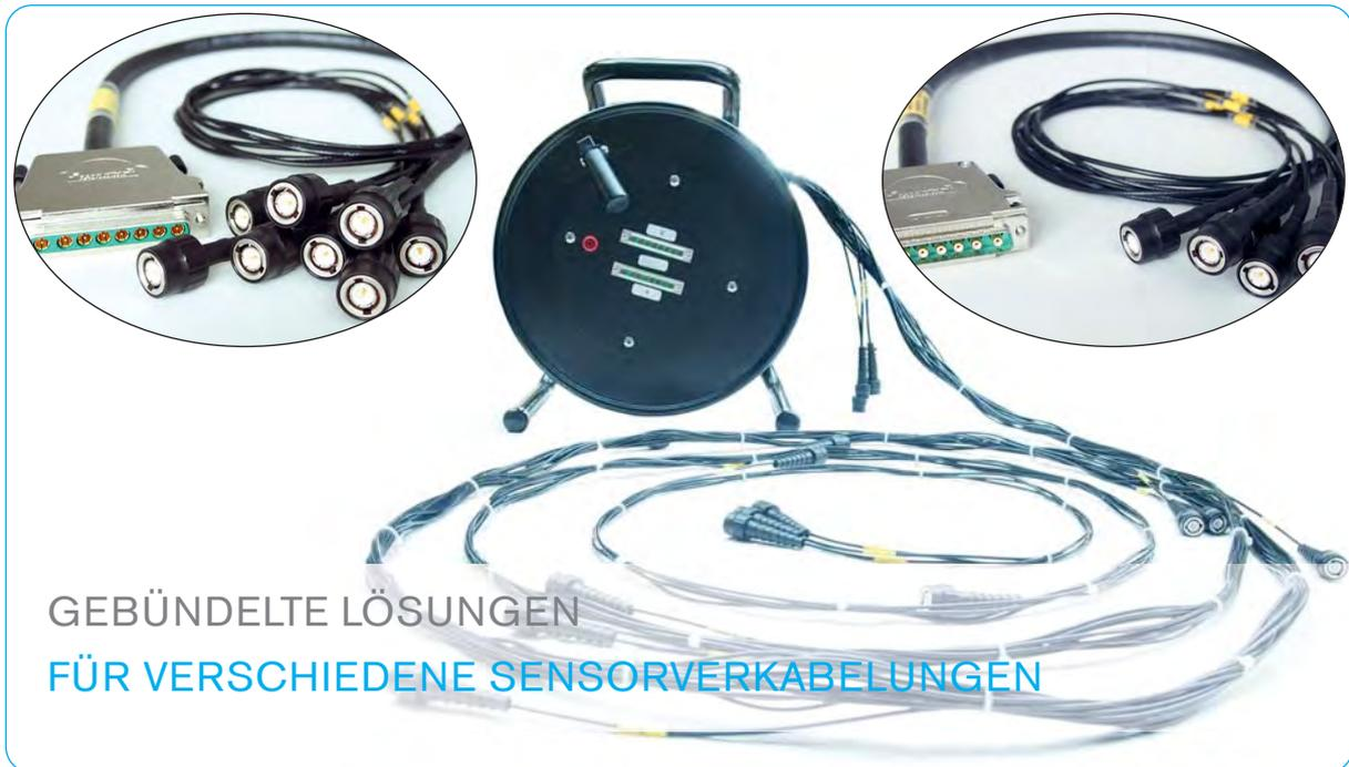
Messaufgaben werden immer komplexer und die Anzahl der auszuwertenden Messstellen steigen. Dadurch erhöht sich der Verkabelungsaufwand. Zur Vereinfachung dieser Aufgabenstellung hat SAB BRÖCKSKES zwei neue Leitungstypen entwickelt. Beide Leitungen sind hochflexibel und robust zugleich. Mit dem verwendeten PUR Außenmantel können Temperaturen von kurzzeitig bis zu +125°C (2500h) erreicht werden. Über lange Verlegestrecken ist eine Montage der Leitung auf einer handlichen Kabeltrommel möglich.
