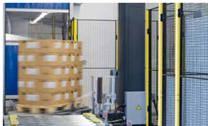
Sicher und bequem von der Produktion ins Lager: Die Paletten werden nach Aufgabe von dem Hubtisch auf Förderniveau gehoben, automatisch gewickelt und über Senkrechtförderer ins EG gefördert.
