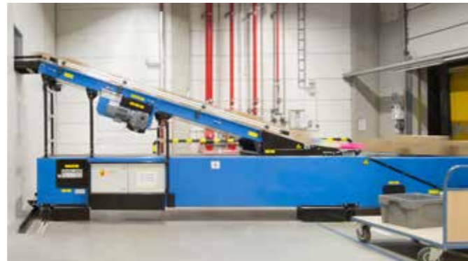
Fluchtweg freigehalten: ein Steigband auf dem seitlich verschiebbaren Teleskopgutförderer transportiert die Kartons auf die Fördertechnik in 2,30 m Höhe. Diese fördert die heterogenen Retouren-Kartons zu vier Erfassungsplätzen.
