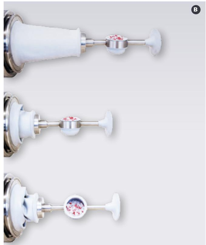
**B:** Ablauf der Probenahme mit dem Löffelprobenehmer
