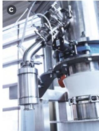
**C:** Vakuumprobenehmer, an einen Vakuumförderer PCC montiert
