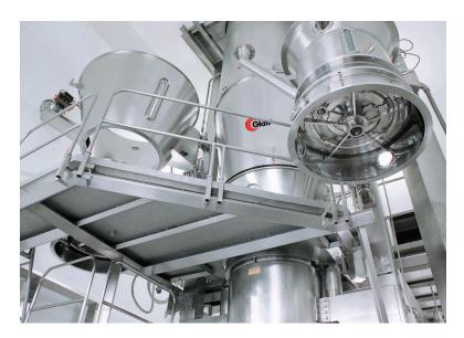
überschreitet der Durchsatz bereits seit Langem den ursprünglich garantierten Wert. Bauseitig wurden dafür eine größere Stiftmühle für die Recyclingleitung, eine größere Siebmaschine und ein neuer Wärmetauscher für die Produktkühlung angeschafft.
