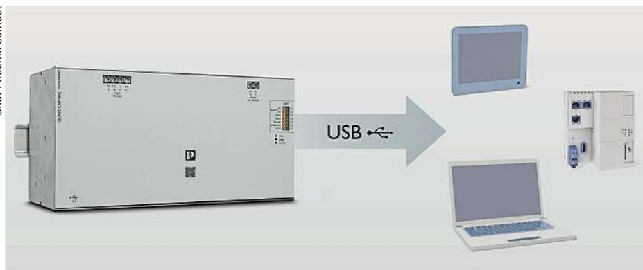
**Bild 2:** Bequemes arbeiten: Überwacht und parametrierbar werden die Anlagen über die USB-Schnittstelle am Puffermodul.
