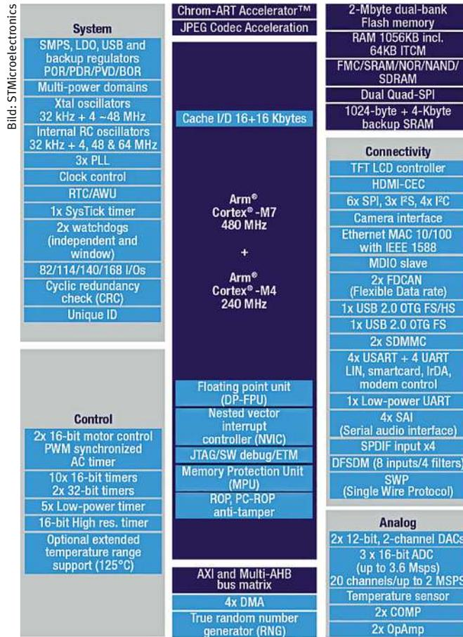
**Bild 1:** Die Dual-Core-Controller der STM32H7-Serie haben eine große Bandbreite unterschiedlicher analoger und digitaler Schnittstellen integriert, deren Daten flexibel von den beiden Cortex-M4- und -M7-Kernen verarbeitet werden können.
