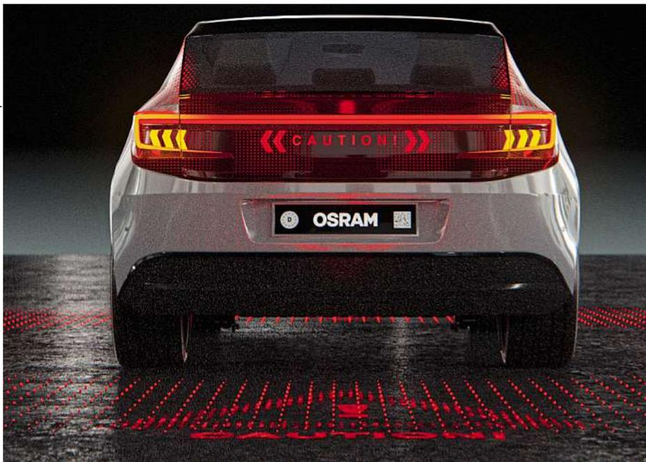
**Bild 5:** Eine Warnung via Kommunikation mit Licht.
