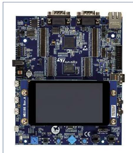
**Bild 5:** Die Baugruppe STM32H757I-EVAL bietet Entwicklern viel Erweiterungsplatz, einfachen Zugang zu Peripheriegeräten und einen LCD-Bildschirm für den Einstieg in Multicore-Anwendungen.
