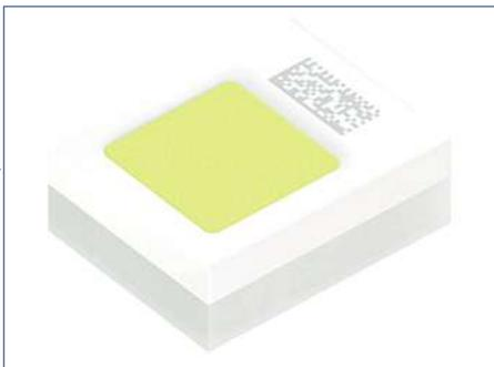
**Bild 1:** Die 1-Chip-Variante der Osram Compact PL liefert einen Helligkeitswert von 395 lm bei einem Strom von 1 A.
