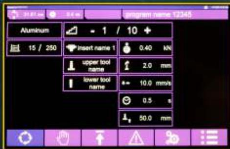
Sicherer Überblick über die Bearbeitungsparameter ist am Bildschirm der TC12 Steuerung jederzeit gegeben, so dass Änderungen schnell möglich sind. Beispiel: Absenkung der Einsatzgeschwindigkeit bei weichen oder empfindlichen Bauteilen.
