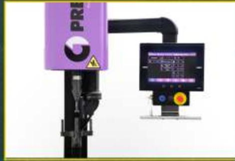
Praktisch für den täglichen Betrieb: Die Bildschirmsteuerung ist schwenkbar an einem Arm montiert. Sie verfügt über einen Assistenten zur Werkzeugeinrichtung samt Datenbank, und bietet unbegrenzte Programmkapazität.
