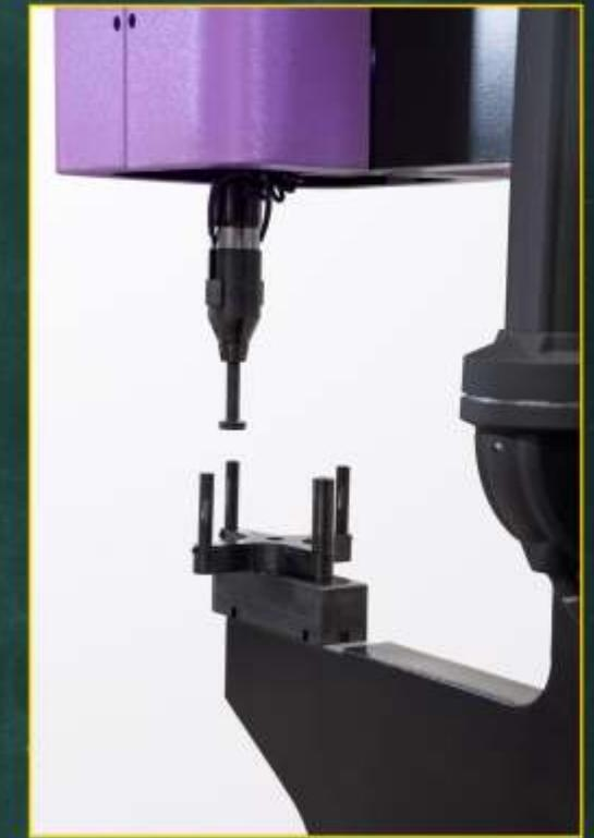
Die Befestigungselemente sitzen auf einem Revolverkopfkarussell mit vier Positionen. Auf Wunsch Ausstattung mit schwenkbarem Bechertisch zum einfachen Greifen der Teile.
