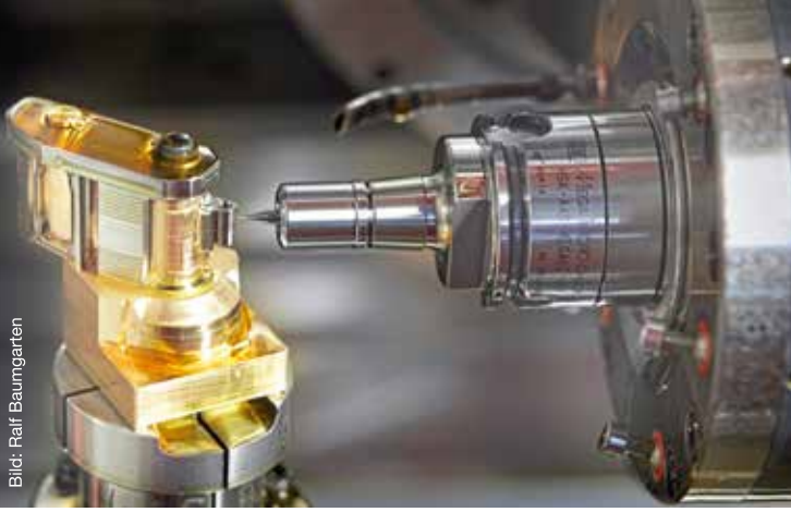
Präzisionsarbeit auf dem 5-Achs-CNC-Dreh-Fräszentrum Bumotec S191 V zur 5-Achs-Bearbeitung: Präzise und komplexe Bauteile werden aus einem Rohling gefräst.
