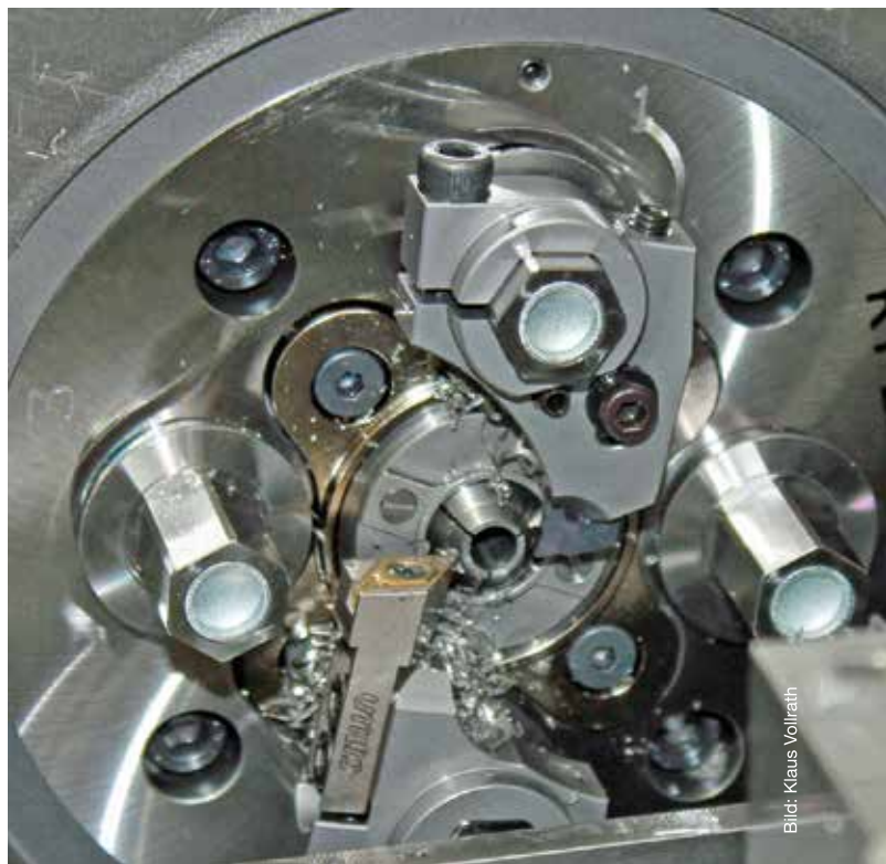
Besonderheit der Escomatic-Anlagen von Esco ist die Bearbeitung des stillstehenden Drahts durch einen schnell rotierenden Werkzeugkopf mit vier unabhängig verstellbaren Werkzeugen. Hier im Bild sind zwei Plätze unbestückt.
