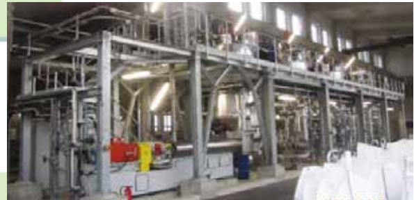
Planung und Errichtung einer Anlage zur Produktion von 4.000 TPA vollsynthetischer Wachse aus Polyethylen und Polypropylen mittels Depolymerisation; Webau / Deutschland, 2016
