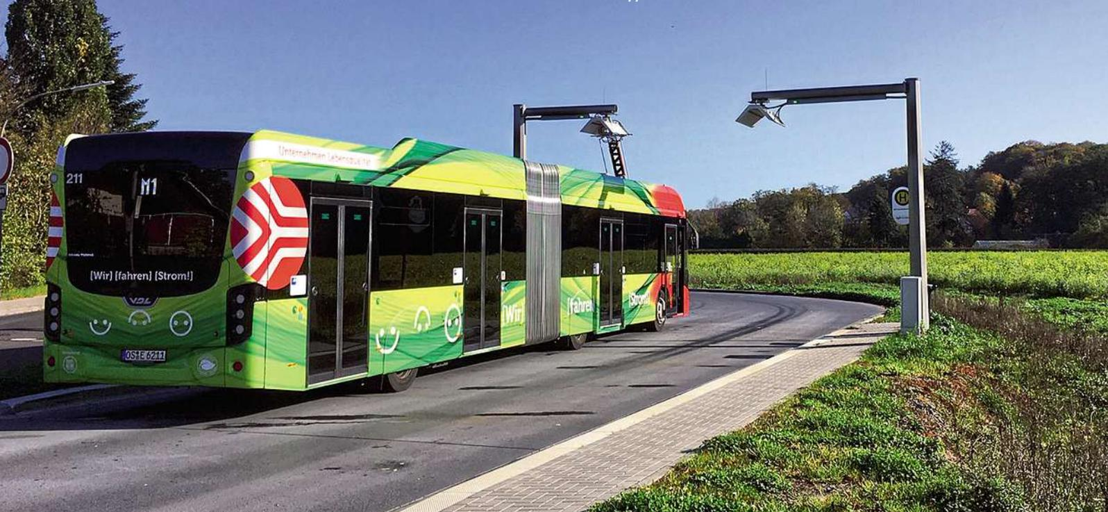
**Schnellladepunkt in Osnabrück:** Die E-Busse werden dort mittels Pantograf-Technologie geladen.
