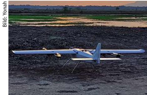
**Bild 1:** Das Projektziel war es, ein tragbares, leicht zu wartendes und robustes Roboterflugzeug zu bauen, das senkrecht starten und landen kann.
