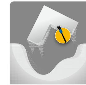
Das überschüssige Pulver wird entfernt
