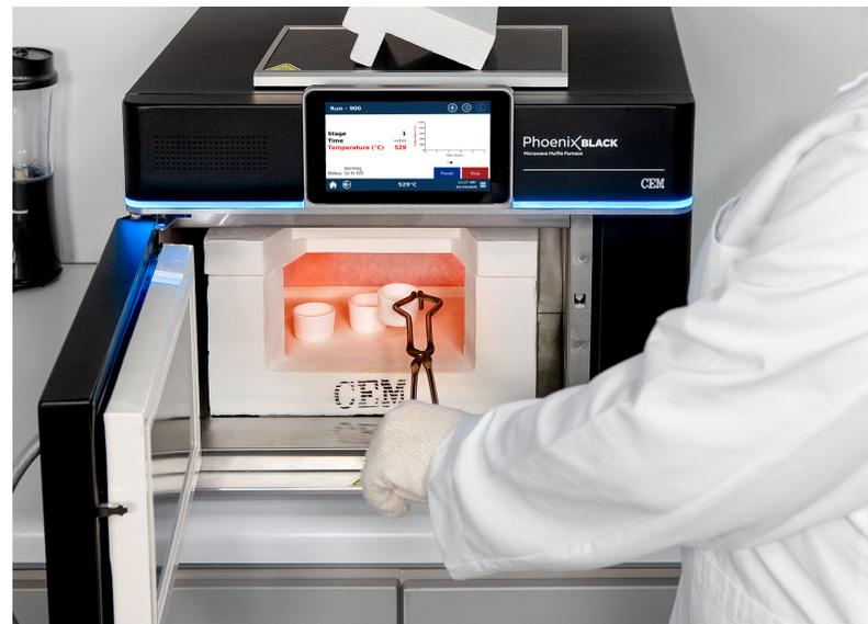
Der Phönix Black Muffelofen kann für Schmelzaufschlüsse und sämtliche Veraschungen mit Temperaturen bis zu 1200 °C benutzt werden
