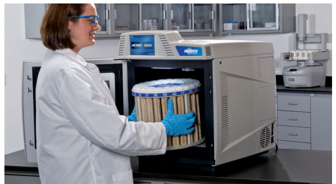
Aufschluss zur Bestimmung von Gesamt-P, CSB-Gehalt und Schwermetalle in Abwasser und Schlämmen im Mars 6
