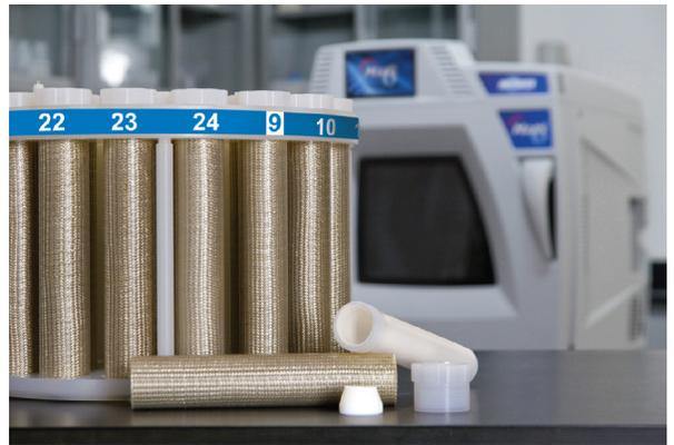
Bis zu 24 Proben können mit diesen Glaseinsätzen im Xpress Plus System schnell und effizient abgearbeitet werden.
