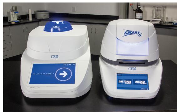
Für eilige feuchte Proben wird in nur 2 min. die Probe im Smart 6 getrocknet und dann binnen Sekunden im ORACLE vermessen
