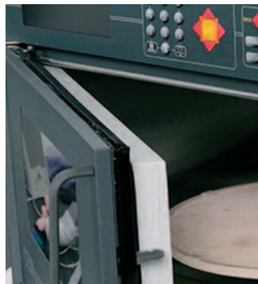
SAM 255: Mikrowellen- Trockenschrank Schneller können viele Proben gleichzeitig nicht getrocknet werden
