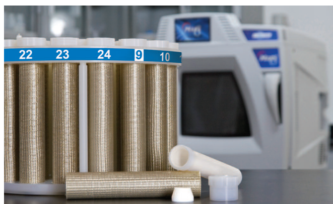
Im Mars 6 können parallel 24 Proben gleichzeitig extrahiert werden und somit der Probendurchsatz gegenüber der klassischen Arbeitsweise enorm gesteigert werden.
