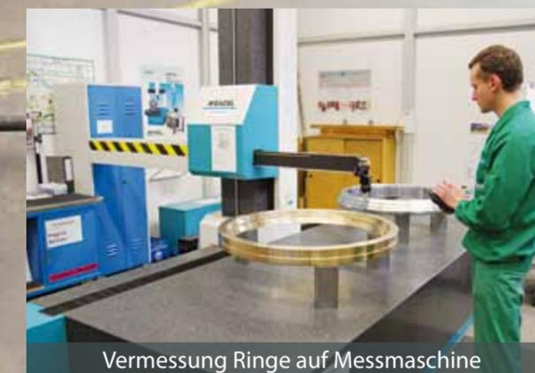
Vermessung Ringe auf Messmaschine
