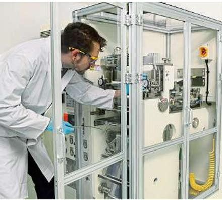
**Coating:** Das Beschichten der Elektroden ist einer von vielen Prozessschritten in der Zellfertigung.
