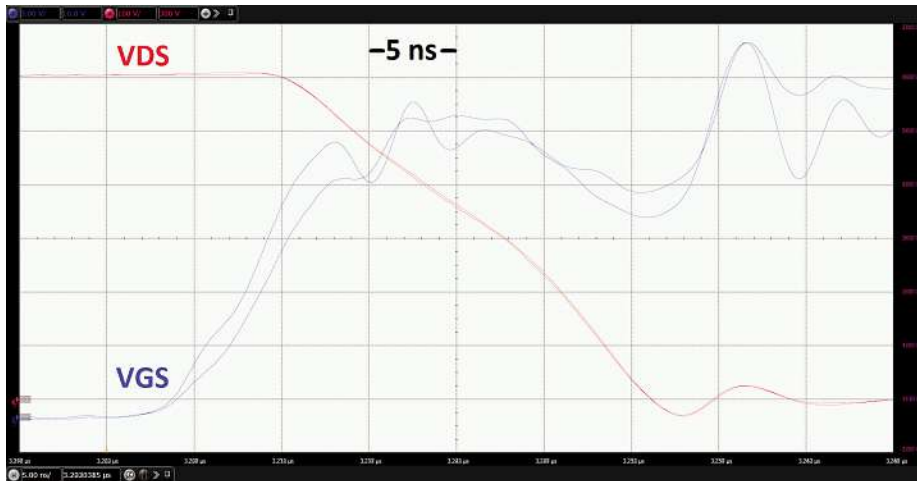
Bild 2: Überlagerte Einschaltssignale mit verschiedenen Positionen des Tastkopfes V_{GS} (blau).
