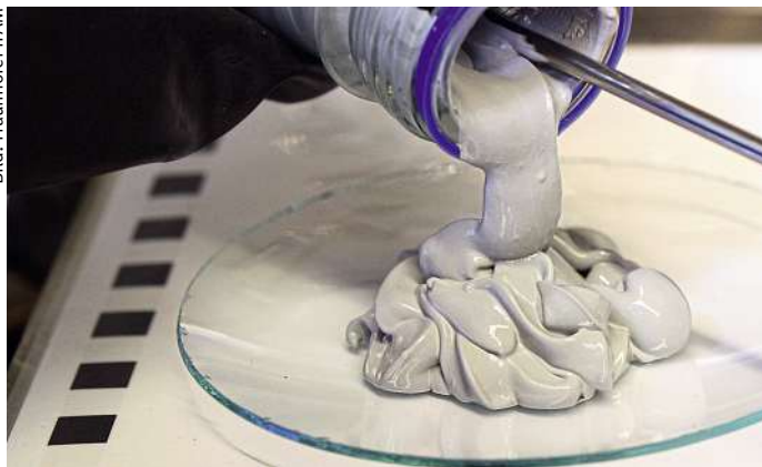
Powerpaste: In ihr lässt sich Wasserstoff auf sichere Weise chemisch speichern, einfach transportieren und ohne teure Tankstellen-Infrastruktur nachtanken.
