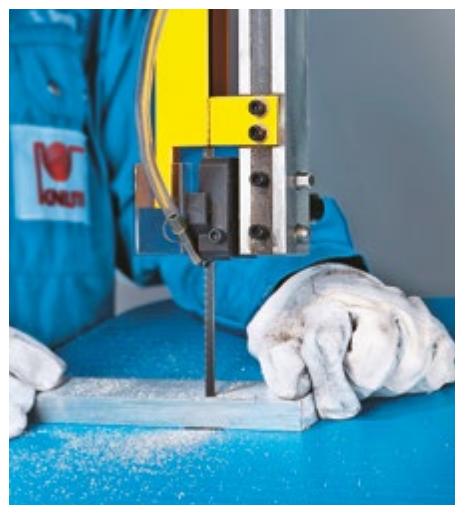
Präzise Sägeblattführung an verschiedene Blattbreiten anpassbar
