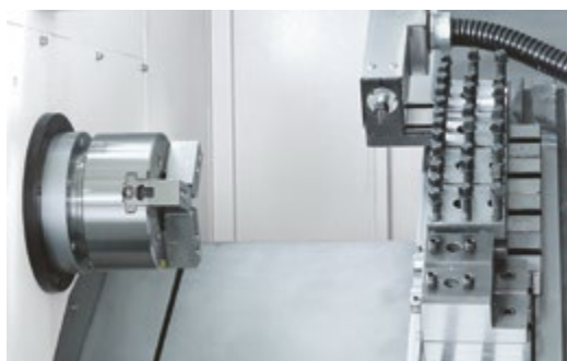
Linearer Werkzeugwechsler mit einem radial angetriebenem Werkzeug
