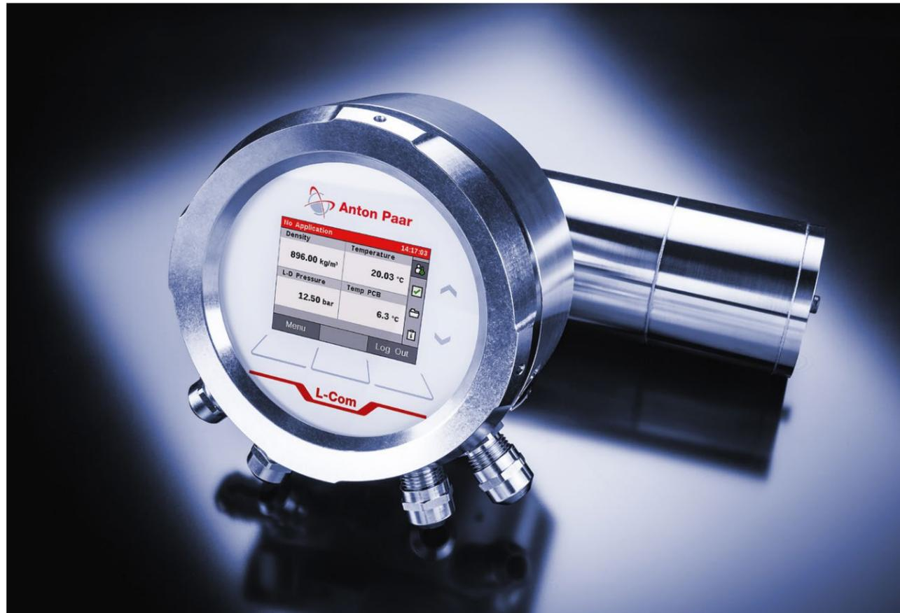
Die gleichzeitige Messung von Dichte und Schallgeschwindigkeit ermöglicht die Konzentrationsmessung von 3-Komponenten-Mischungen wie Formaldehyd-Methanol-Wasser, Ethanol-Zucker-Wasser und Alkohol-Extrakt-Wasser. L-Com 5500 kombiniert die Dichte- und Schallgeschwindigkeitsmessung, um Ihnen das Beste aus beiden Welten zu bieten. Er besteht aus einem piezo-angeregten Schwingerrohr in W-Form, das mit einem zusätzlichen Schallgeschwindigkeitsmodul erweitert wurde.
