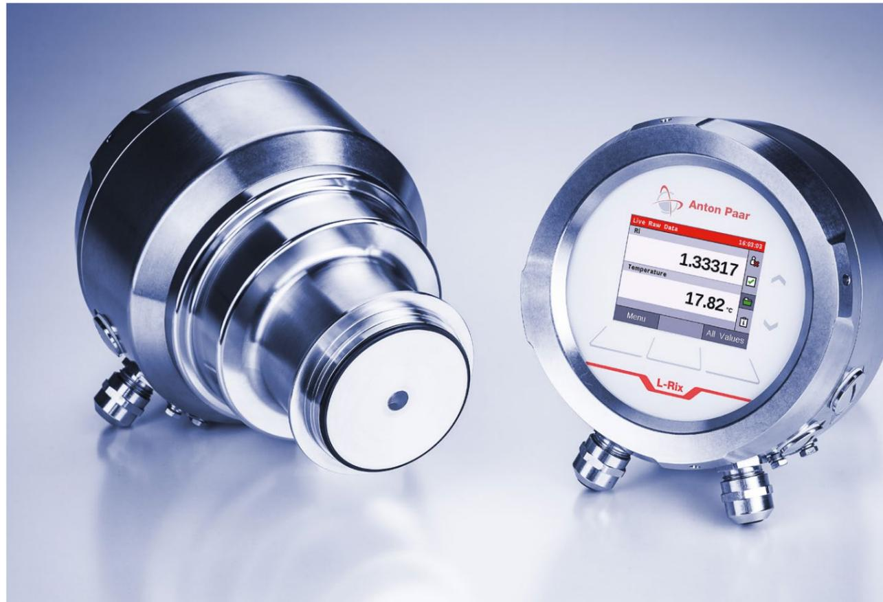
L-Rix 5000/5100/5200 sind langlebige und wartungsfreie Inline-Refraktometer für Echtzeit-Konzentrationsmessungen und die Produktionskontrolle von Roh-, Zwischen- und Endprodukten. Die Sensoren zeigen kontinuierlich den Brechungsindex oder die Zuckerkonzentration bei der entsprechenden Prozesstemperatur an und ermöglichen somit eine Produktionsüberwachung rund um die Uhr. Da die Sensoren von Streulicht nicht beeinflusst werden, können sie in Produktionslinien mit Sichtfenstern eingesetzt werden.
