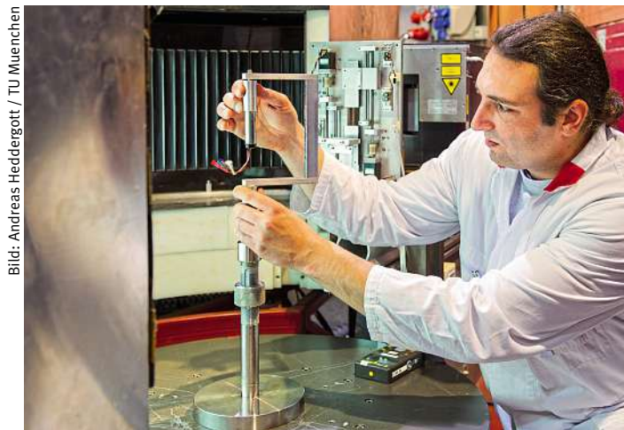
Montage einer Lithium-Ionen-Zelle: Martin Mühlbauer befestigt sie im Objektträger des hochauflösenden Pulverdiffraktometers (SPODI) am FRM II.
