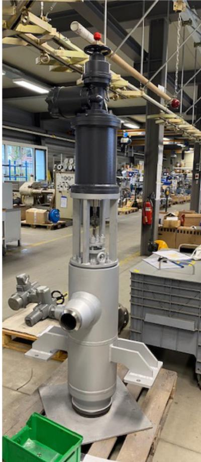
Vor einigen Monaten ging bei unserem Kunden aus der Chemie die Dampfumformstation Baureihe 580 in Betrieb und ersetzte damit eine störanfällige Armatur, bei der in regelmäßigen Abständen die komplette Innengarnitur aufgrund von starkem Verschleiß kostenaufwendig ersetzt werden musste. Die Mitarbeiter der Arca waren mehrmals vor Ort und erarbeiteten gemeinsam mit dem Kunden eine Lösung für die technisch anspruchsvolle Aufgabenstellung.
