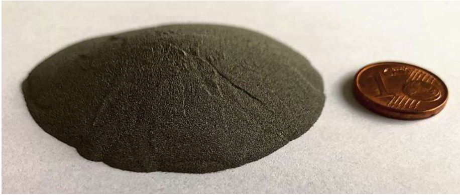
Bild 2: Diese Pulvermenge des Edelstahls 1.4404 wird für den Aufbau eines IQ-Big 53 benötigt.
