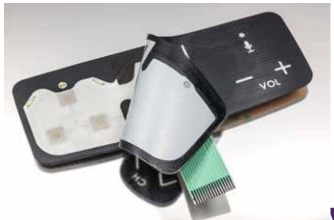
Beleuchtete Tasten mit der LGF Technologie
