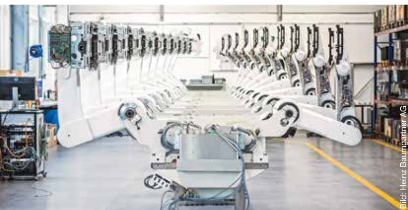
Diese hoch komplexen Roboterarme für Tumor-Bestrahlungssysteme für die Medizintechnik werden gefertigt und montiert. Die Qualitätskontrolle und Endabnahme findet in enger Zusammenarbeit mit dem Kunden vor Ort statt.
