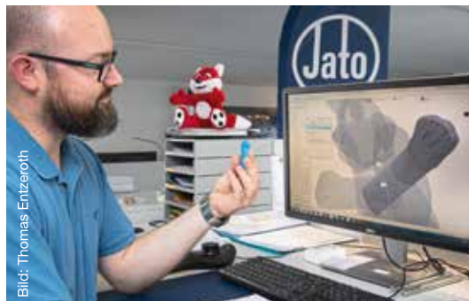
Um auch kleinere Details zu kontrollieren, wurden zusätzlich einzelne Körperteile der Figur ausgedruckt. So musste beispielsweise die Tiefe der Rillen bei den Fingern genau geprüft werden.
