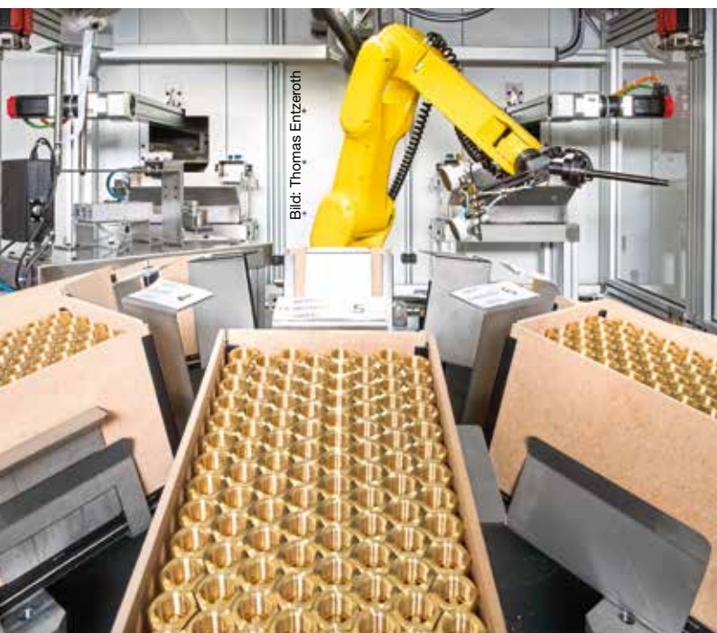
Blick in die Handling- und Verpackungsbereich der Fertigungszelle: bevor die Düsen verpackt werden, werden sie per Kamera geprüft und in regelmässigen Abständen vermessen.
