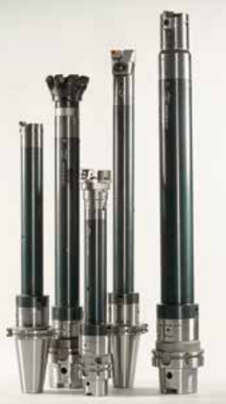
Das Schnellwechsel-Reibsystem (D = 140-200 mm) «RX-large» mit patentierter Aufnahme und Kurzkegel garantiert eine Wechselgenauigkeit von 5 µm. Bildmitte die neuen URMA Antivibrations-Bohrstangen «VAS». Rechts: Das neue «URMA Boring System Gamma» ist System-unabhängig und dank Weldon-Zylinderschaft multifunktional einsetzbar.
