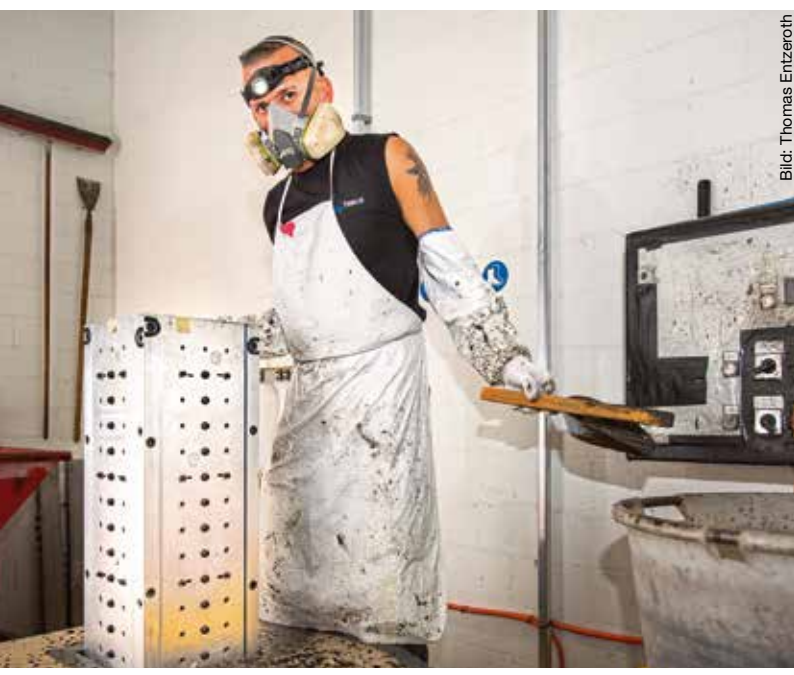
Fertigungstiefe und Swiss made in Perfektion: Die Polymerbeton-Spanntürme («tripoxyMINERAL») werden alle inhouse bei der Triag International AG gefertigt, übrigens mit Schweizer Kies vom Thunersee.
