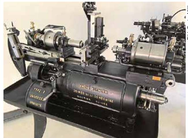
Aus dem Centre Muller: Langdrehautomat Bechler Typ V, Spindeldurchlass 25 mm, mit 3 Drehstählen und einfachem Bohraparat, Maschine mit beweglichem Spindelstock.
