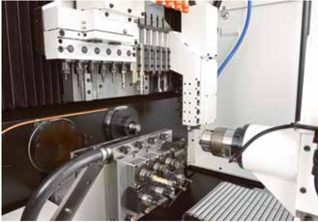
Das neue Modell SY2-42E von CCM ist durch eine grosse Flexibilität gekennzeichnet. Der CNC-Hybrid-Lang- und Kurzdrehautomat ermöglicht einen Stangendurchlass bis \varnothing 42 mm.
