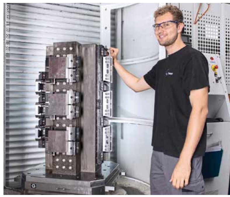
Die «tripoxyMINERAL» Spanntürme verfügen über hervorragende Schwingungsdämpfung. Ein weiterer Vorteil ist das relativ geringe Gewicht der Polymerbeton-Spanntürme.
