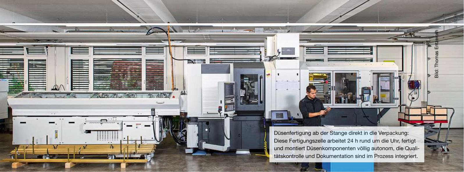
Düsenfertigung ab der Stange direkt in die Verpackung: Diese Fertigungszelle arbeitet 24 h rund um die Uhr, fertigt und montiert Düsenkomponenten völlig autonom, die Qualitätskontrolle und Dokumentation sind im Prozess integriert.
