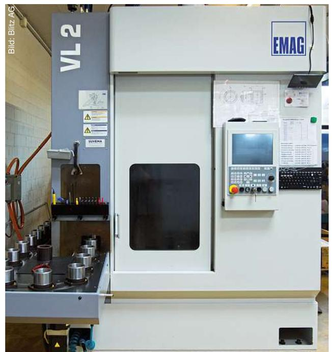
Die Vertikal-Dreh- und Fräsmaschine EMAG VL2 ist für Wellen- und Futterteile geeignet.
