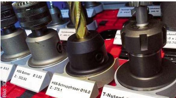
Der cnc-data-clip ist ein einfacher Etikettenhalter zur übersichtlichen Werkzeugbeschriftung.
