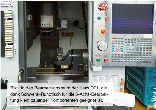
Blick in den Bearbeitungsraum der Haas DT1, die dank Schwenk-Rundtisch für die 5-Achs-Bearbeitung klein bauender Komponenten geeignet ist.
