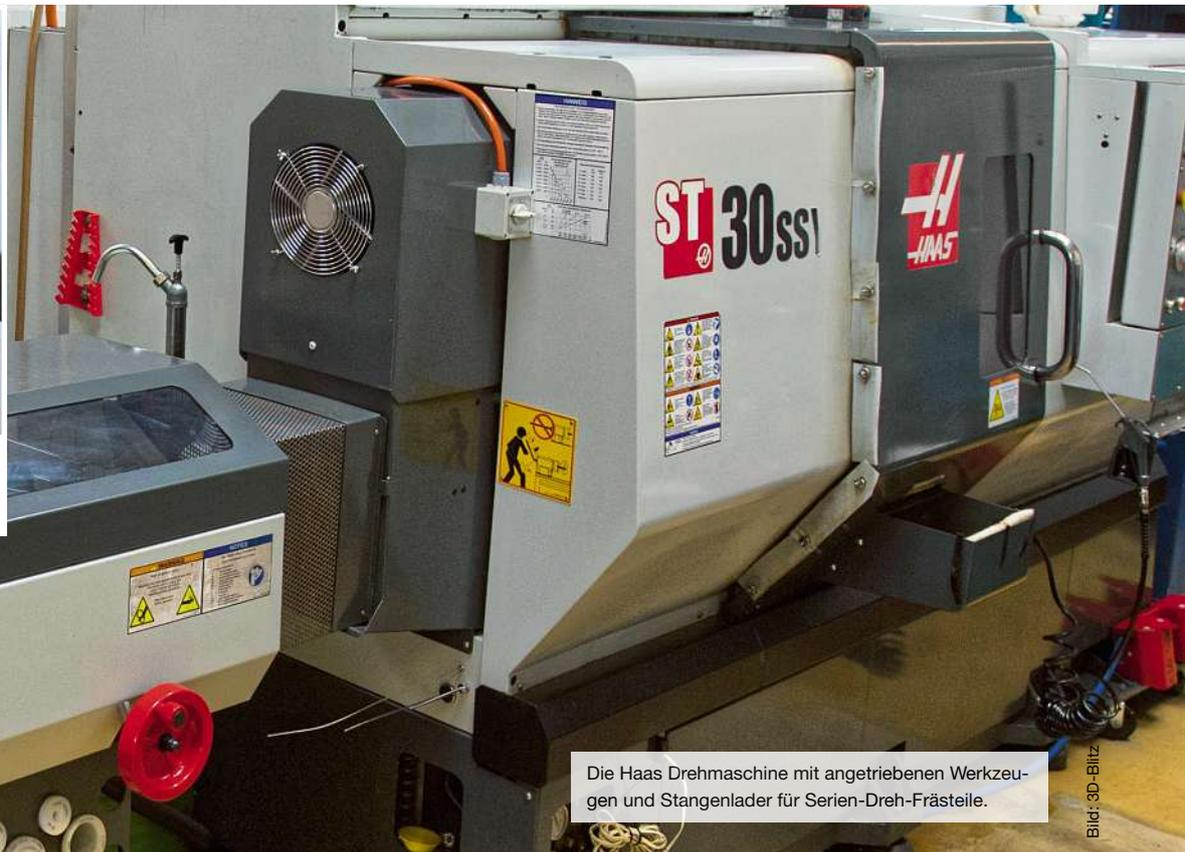
Die Haas Drehmaschine mit angetriebenen Werkzeugen und Stangenlager für Serien-Dreh-Frästeile.
