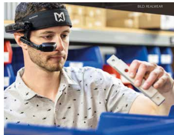
Die modulare AR-Brille Realwear Navigator 500 ist mit einer 48-MP-Kamera ausgestattet.
