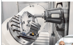
Die Universalreihe von GROB zur 4-Achsen-Simultanbearbeitung eines geschwungenen Bauteils.
