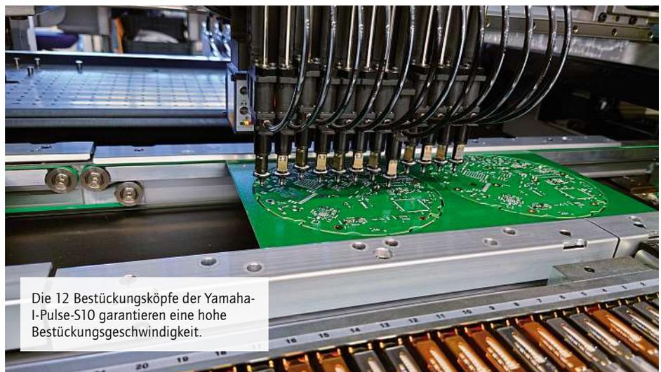
Die 12 Bestückungsköpfe der Yamaha-I-Pulse-S10 garantieren eine hohe Bestückungsgeschwindigkeit.
