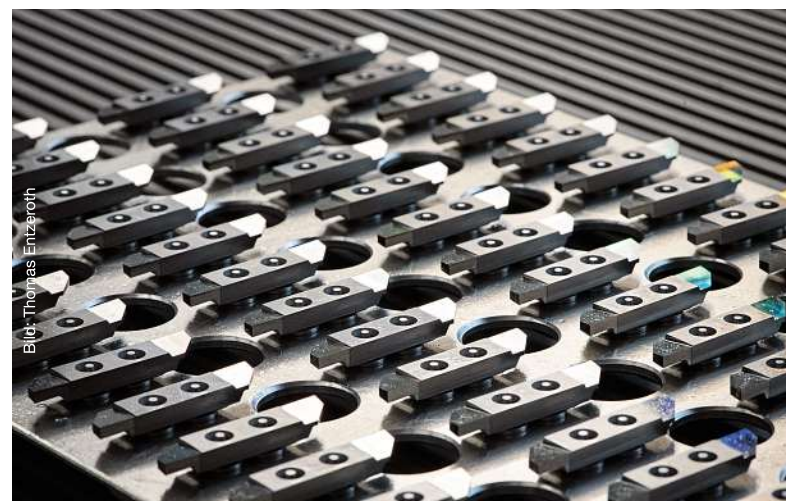
Präzisionsschliff: Alle Schneiden der Applitec-Vollhartmetallwerkzeuge sind präzisionsgeschliffen ohne Ausnahme und erreichen dadurch entsprechend hohe Qualitätsstandards in der Zerspanung.
