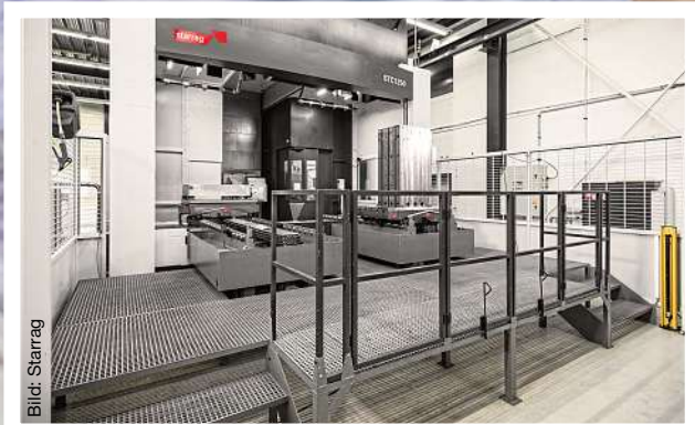
Die Starrag STC 1250 sorgt für deutliche Produktivitätssteigerung bei der Schaufelbearbeitung.
