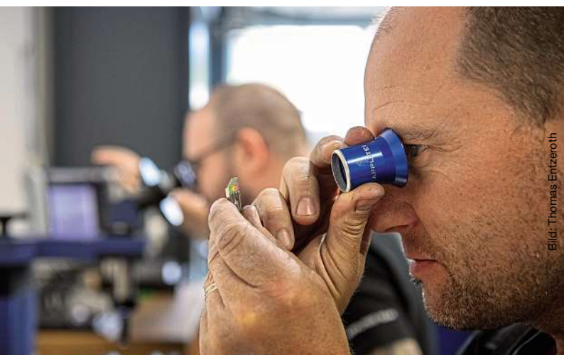
Perfektionismus: Neben automatisierten Qualitätssicherung kommt die fachmännische Qualitätskontrolle der Wendeschneidplatten zum Zug, so das 100 Prozent perfekte «Schneidkanten» das Werk verlassen.
