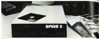
Das Computermodell Sage ist jetzt auch als Platine erhältlich. Die Platine enthält 256-KByte-Hauptspeicher, einen Floppy-Controller, zwei V24-Schnittstellen, eine Centronics- und eine IEEE-488-Schnittstelle sowie Sockel zum Erweitern des Hauptspeichers auf 512 KByte. Auf dem System laufen zwölf Betriebssysteme, darunter UCSD-Pascal, CP/M 68K, IDRIS (Unix) und über 50 Compiler, darunter APL, Lips und Mumps.
