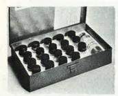
Temperaturempfindliche Lacke zeigen durch eine scharfen Umschlag der Farbe das Erreichen oder Überschreiten einer bestimmten Oberflächentemperatur an. Damit kann das ganze Objekt kontrolliert werden.
