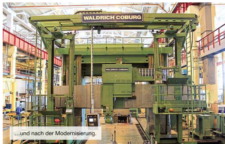
Beispiel einer über 40 Jahre alten Gantry-Fräsmaschine vor...
