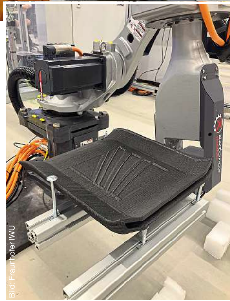
Standardmaschinen vernetzen und Bauteile flexibel herstellen: Anwendungsbeispiel Sitzschale.
