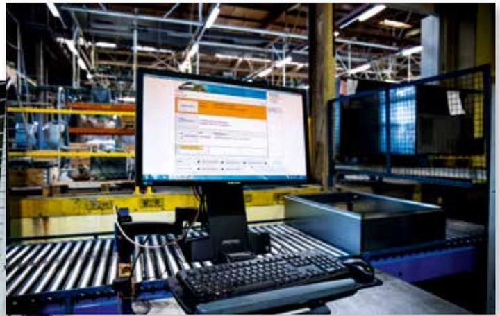
Für die Handarbeitsplätze erfasst Schneider Electric die Betriebsdaten mit der BDE-Software von Proxia. In Kombination mit der MDE-Software entsteht so ein Abbild der Fertigungssituation.
