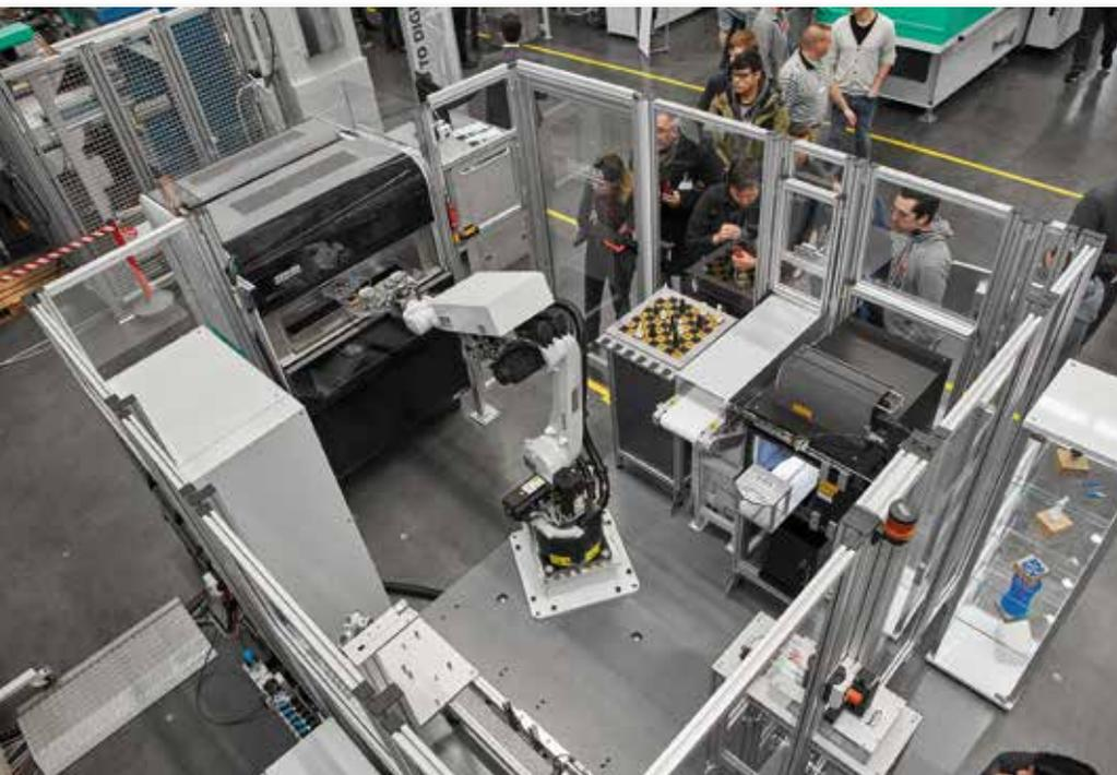
„AM Factory“: Eine IT-vernetzte Turnkey-Anlage rund um einen Freeformer 300-3X funktionalisiert auf vollautomatisierte Weise Greiferplatten.
