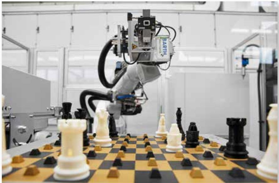
Dank der individualisierten Greiferplatte kann der Sechs-Achs-Roboter die ausgewählte Figur auf dem Schachbrett umsetzen.
