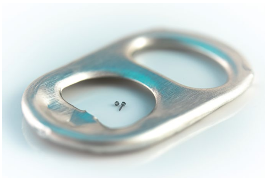
3D-gedruckte Mikromutter und Schraube im Vergleich zu einem Dosenöffner.
