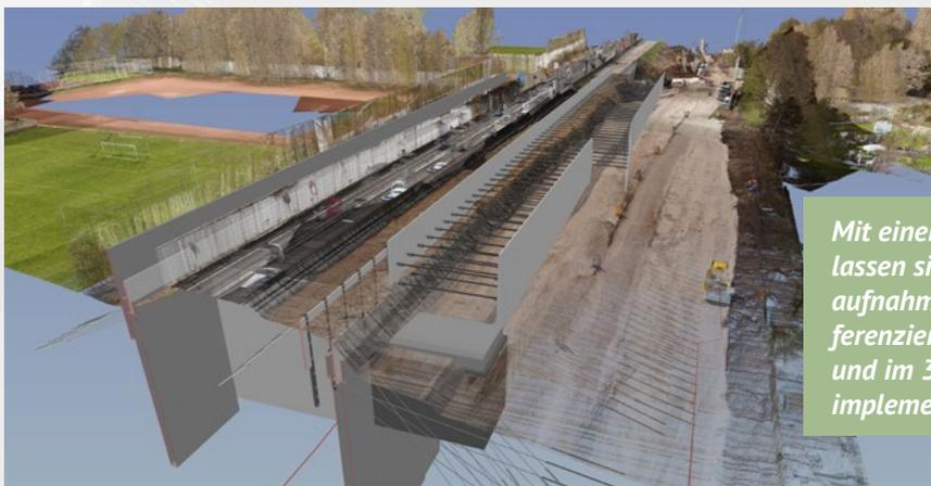
Mit einem 3D-Laser lassen sich Bestandsaufnahmen georeferenziert erfassen und im 3D-Modell implementieren.
