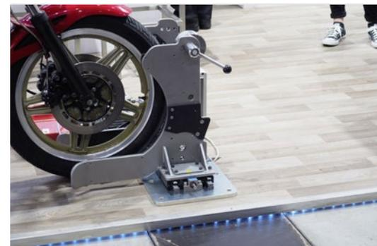
*Bild 2: Beim Motorrad wird in der Regel das Hinterrad angetrieben. Deswegen gilt es, das Vorderrad aufzunehmen, zu klemmen und sicher zu fixieren.*
