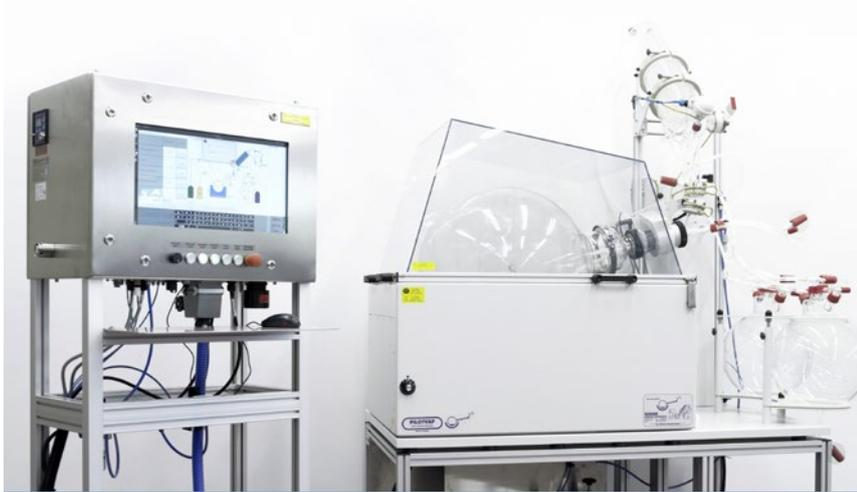
Durch das Hochleistungsdichtsystem und die oberflächenbehandelten Glasflansche erreichen die Rotationsverdampfer von Genser bestmögliche Vakuumstabilität.
