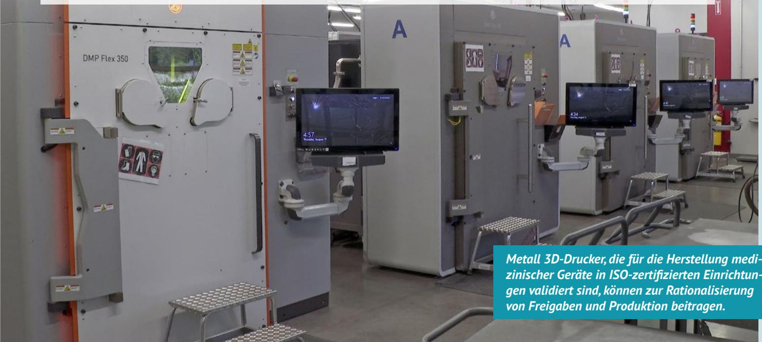
**Metall 3D-Drucker, die für die Herstellung medizinischer Geräte in ISO-zertifizierten Einrichtungen validiert sind, können zur Rationalisierung von Freigaben und Produktion beitragen.**
