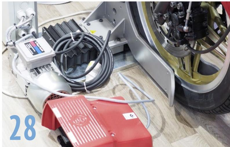
**KONSTRUKTIONSBAUTEILE:** Die S. Bleyer GmbH fertigt Lösungen, mit denen sich Fahrzeuge auf Prüfständen sicher fixieren lassen. Zu den Neuentwicklungen gehört nun auch eine Vorrichtung für Motorräder. Diese soll sowohl Dauertests standhalten können als auch leicht zu bedienen sein. Verbaut sind leistungsfähige Schienenführungen.
