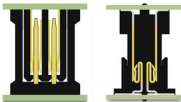
**Bild 2a und 2b: Klassischer Doppel- und Single-Beam-Kontakt.**
