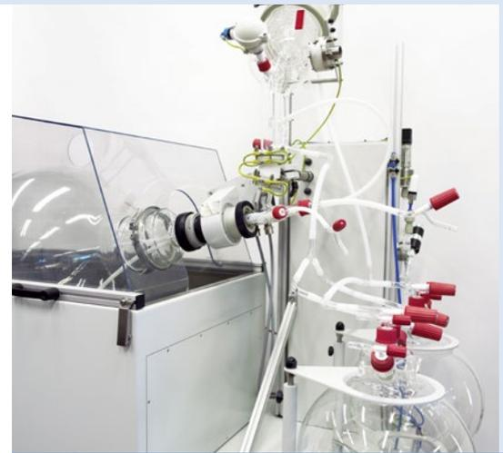
Die Motoren, die den Destillationskolben des Verdampfers in Rotation versetzen, müssen explosionsgeschützt und zuverlässig sein.
