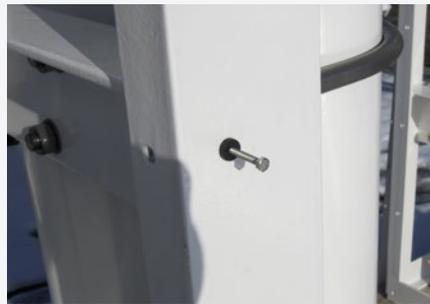
**Flex Locs Schnellbefestigungselemente schützen das Gehäuse der Aussetzvorrichtung, in dem Druckflaschen zum Notfallwassern untergebracht sind.**
