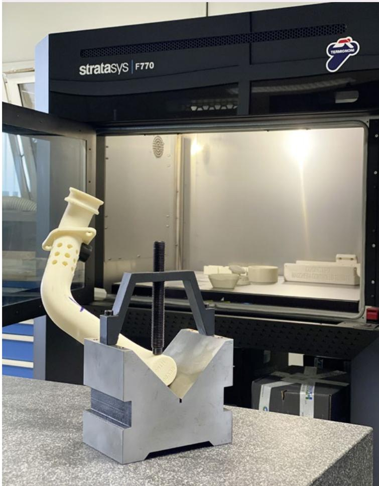
Hochleistungs-ASA-Filament bietet Termignoni die mechanischen und ästhetischen Eigenschaften, die für den präzisen und zuverlässigen 3D-Druck komplexer Prototypen erforderlich sind.
