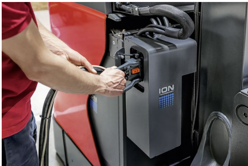
Die Lithium-Ionen-Batterietechnik bietet viele Vorzüge – unter anderem das Zwischenladen, wodurch Batteriewechsel obsolet werden.
