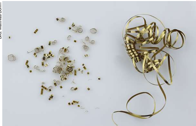
Das Ergebnis der Entwicklung. Rechts Endlosspäne beim Drehen von Bleifrei-Messing CuZn42 / 40 mit WSP ohne Spanbrecher. Links das Spanbild mit den neuen TOP-Watch-Schneideinsätzen mit Spanbrecher.
