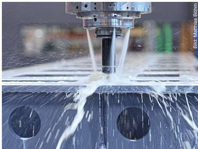
Detailansicht: Gewindefertigung des Maschinenbetts der MATEC 30HV auf einer MATEC 50P bei der PRO-CAM CNC AG im März 2024.
