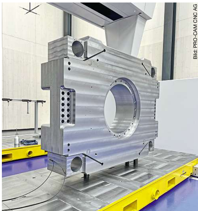
Auch Kundenaufträge werden bei PRO-CAM CNC AG vermessen: Hier hat PRO-CAM CNC AG im Jahr 2021 in eine Zeiss MMZ G (X: 4000 mm, Y: 9000 mm, Z: 2500 mm) investiert, die nach eigener Aussage von H. Krähenbühl die derzeit grösste Zeiss Messmaschine der Schweiz sei.
