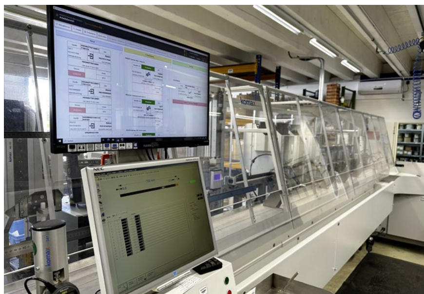
Alles auf einen Blick bei den Apteon-Anwendern des Kabelkonfektionierers HIK in Oberzent: Mit den Kanban-BDE-Boards gelangen fertigungsbezogene Daten direkt an die Maschinen und Montagearbeitsplätze und werden von dort aus unmittelbar an das ERP-System zurückgemeldet. Bild: HIK
