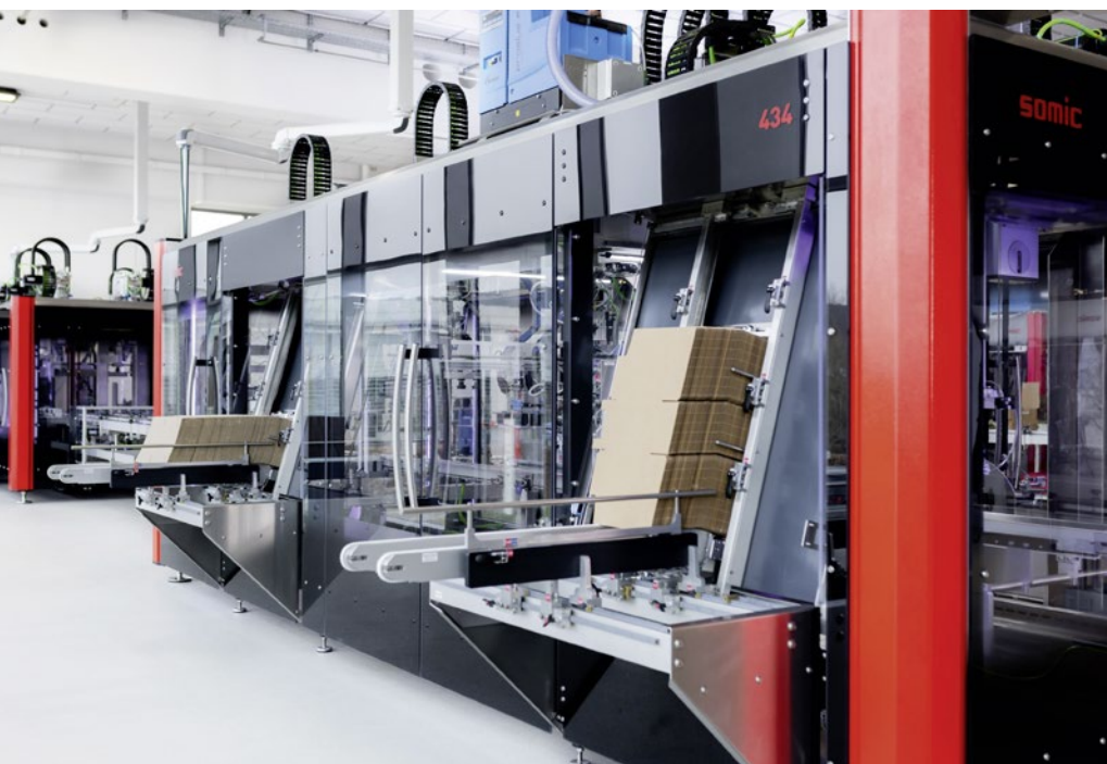
Die Verpackungsmaschinen von Somic kartonieren vorverpackte Produkte vollautomatisch. Sie sorgen für einen sicheren Transport und eine attraktive Präsentation im Handel.
