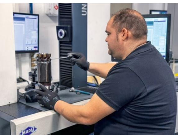
Werkzeugeinsteller Sergio Aranda an einer HPR400 Reibahle für die Fertigbearbeitung der Kurbelwellenlagergasse.
