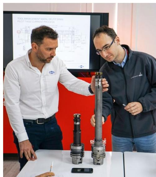
David Castaño und Manuel Padilla Fernández zeigen die Unterschiede der HPR400 Reibahle im Vergleich zum zuvor eingesetzten Feinbohrwerkzeug mit HX-Wendeschneidplatten.
