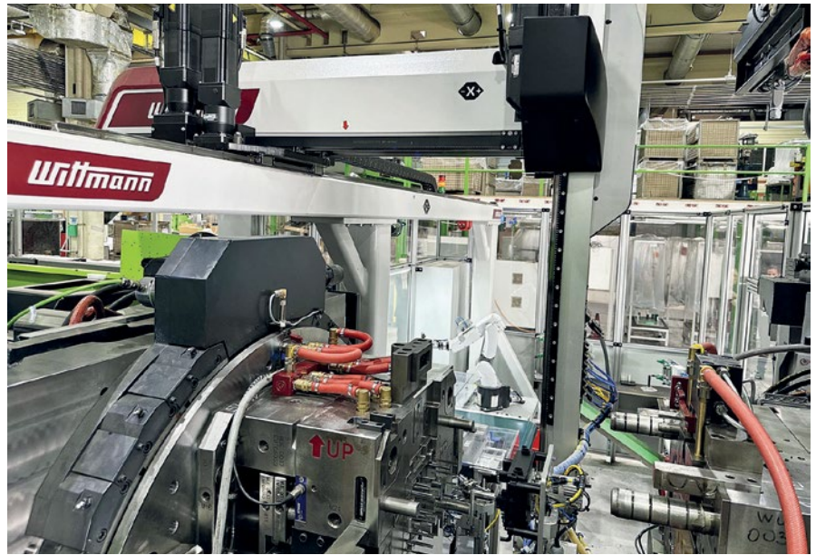
Der Linearroboter W832 Pro von Wittmann ist das Bindeglied zwischen der Spritzgießverarbeitung und den nachfolgenden Arbeitsschritten.
