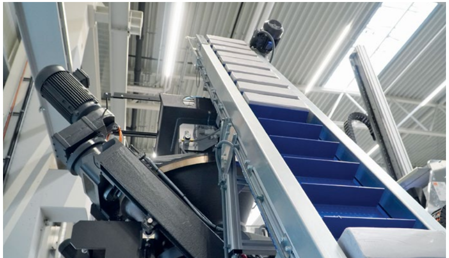
Über ein Förderband werden die Kautschukblöcke der Spritzgießmaschine bedarfsgerecht zugeführt.
