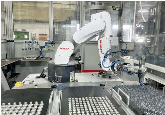
Der Prozess startet mit der Bereitstellung der Einlege­teile. Hier von einem Roboter übernommen.
