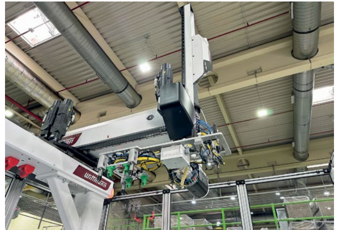
Der Wittmann Roboter arbeitet mit verschiedenen Greifern, um 18 Produktvarianten flexibel zu unterstützen.
