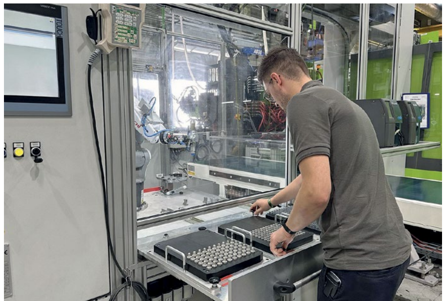
Während der Vorserie werden die Einlegeteile noch manuell zugeführt. Für den Einsatz von Rütteltöpfen, Bunkern und Vereinzelern ist alles vorbereitet.
